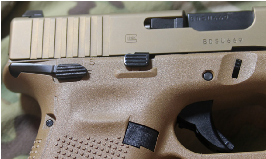
Die Bedienelemente von der rechten Waffenseite: Sicherungs- und Verschlussfanghebel sowie Zerlegehebel sind beidseitig angebracht, der Magazinhalteknopf lässt sich bei Bedarf umstecken.
