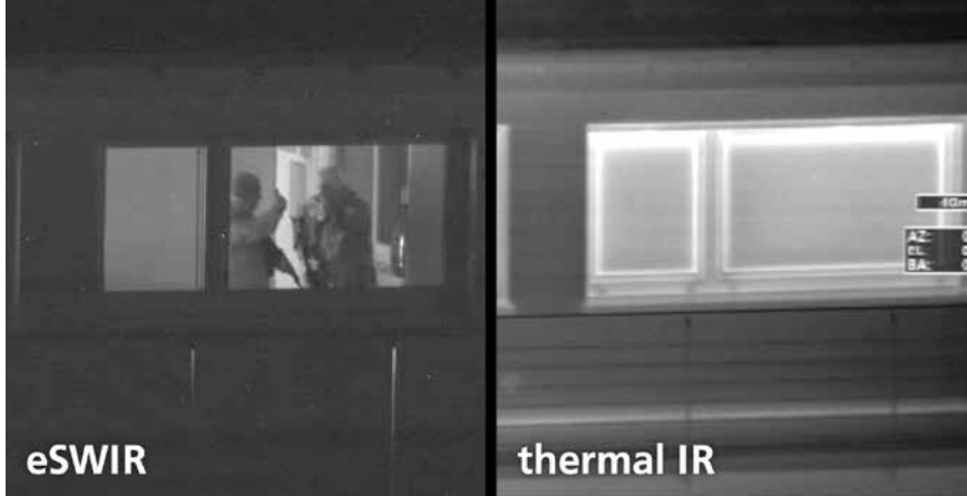
Personen hinter einem Fenster – links das eSWIR-Bild, rechts durch ein Wärmebildgerät
